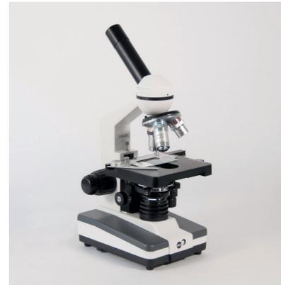
Similar al modelo 03 A pero incorporando, además, pinzas articuladas y carro para la sujeción y el movimiento de las preparaciones.
